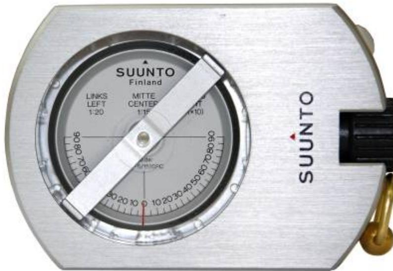
С помощью высотомера Suunto PM-5/1250 можно точно и быстро измерять высоту деревьев. Разрешающая способность  $\pm 1-2\%$ . Наводка и взятие отсчета по шкале происходят одновременно. Регулирование или блокировка шкалы не требуются. На высотомере имеются шкалы для измерения, высоты с расстояния 15 и 20 м.
